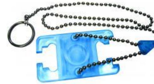
Figure 5 : Relascope à chaînette
